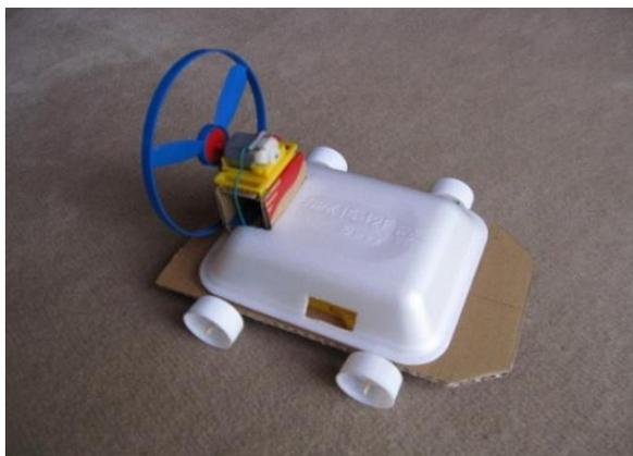
内 容： 発泡スチロールトレイ、ダンボール、ボトルキャップで作った4輪車模型に小型モーターで回すプロペラをつける。プロペラで走る車のメカニズムとモーターの回転と電池の配線と働きを学びます。
